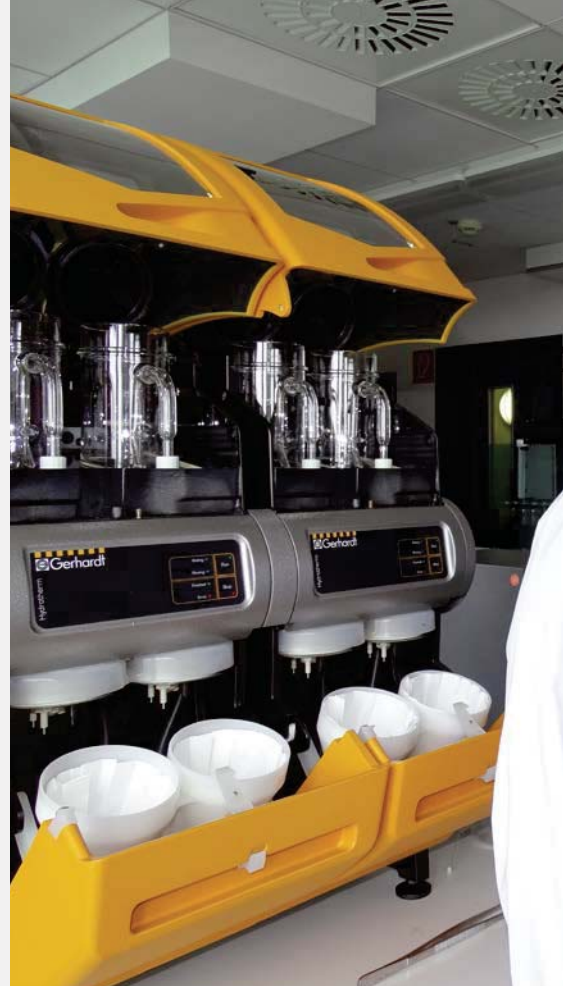
Laborleiterin Dörthe Frese vor der Anlage zur automatisierten Fettbestimmung nach Weibull-Stoldt
