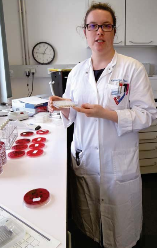
Biologielaborantin Katharina Engel erstellt ein Antibiotogramm zur Resistenzprüfung von Bakterien.
