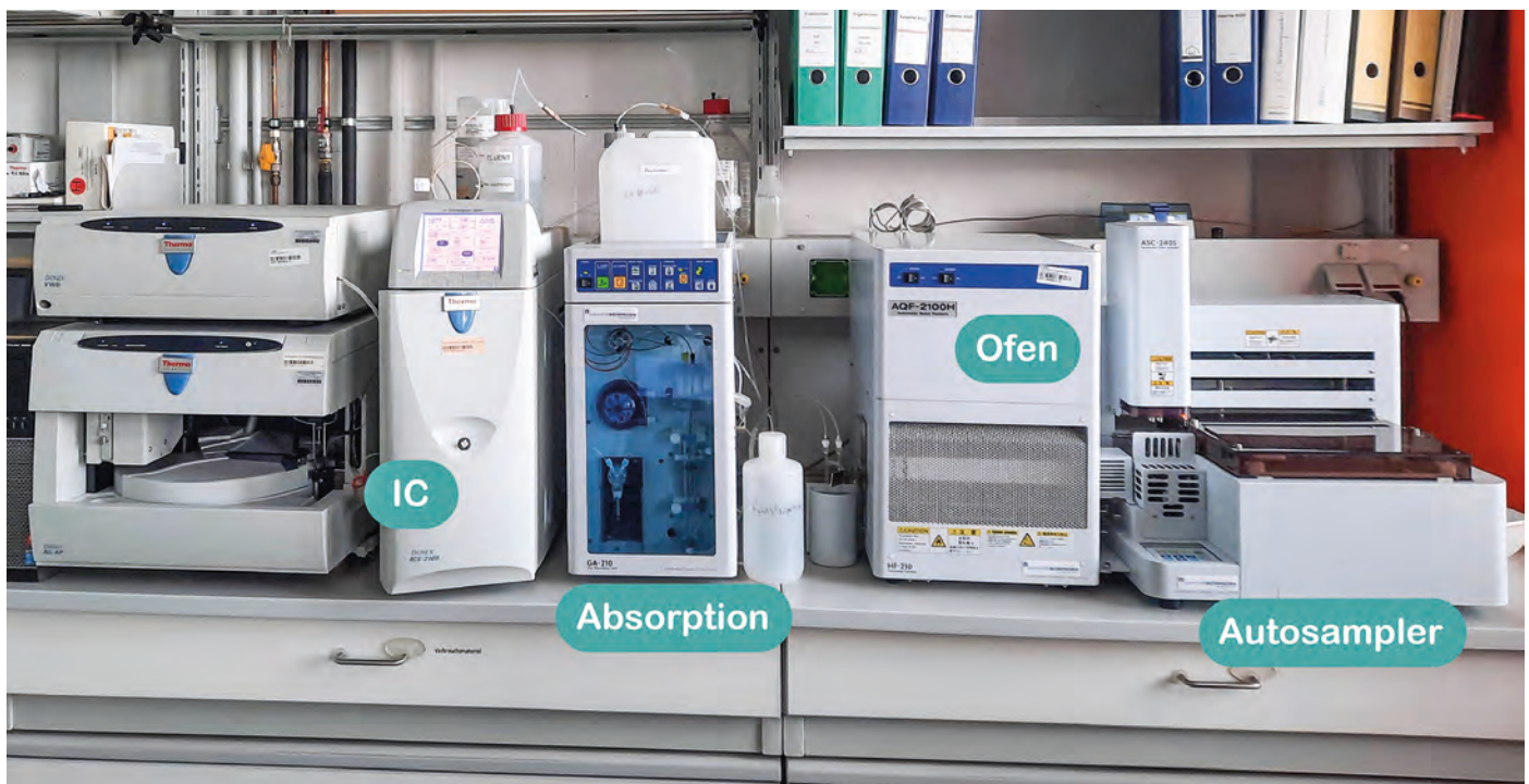
Abb. 13: Schematische Darstellung der Verbrennungs-Ionen-Chromatographie (CIC) zur Bestimmung von adsorbierbarem organisch gebundenen Fluor (AOF).
